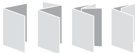
Einfachfalz, Zickzackfalz, doppelter Parallelfalz und Wickelfalz.
