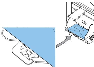
3. Kuvert (mit geschlossener Lasche) zwischen die Maschinenrollen schieben und Knopf **A** nach rechts drehen, bis beim Hineinschieben und Herausziehen des Kuverts ein leichter Widerstand fühlbar ist.
