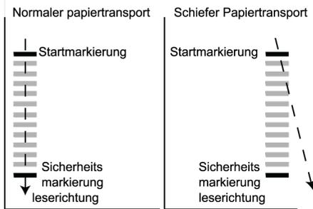
Der Mindestcode ist eine Markierung in einer Zeile (Kuvertierung). Aus Gründen der Zuverlässigkeit wird jedoch empfohlen, mindestens 2 Markierungen zu verwenden. Die erste Zeile ist die Startmarkierung. Eine Markierung auf der zweiten Zeile bedeutet Kuvertieren. Keine Markierung auf der zweiten Zeile bedeutet Sammeln.
