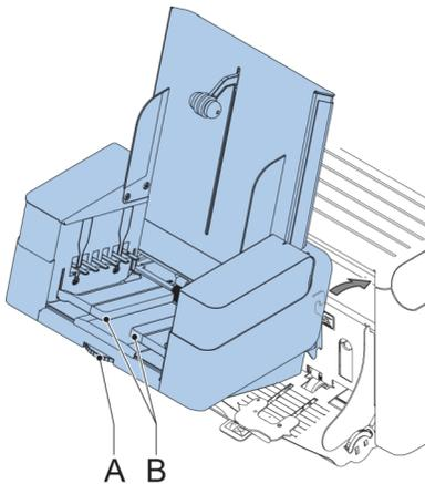
Die vertikale Ablage mit hoher Kapazität kann zum Stapeln gefüllter Kuverts verwendet werden. Die vertikale Ablage kann bis zu 325 gefüllte Kuverts aufnehmen. Wenn Sie über eine vertikale Ablage mit hoher Kapazität verfügen, bringen Sie diese wie folgt am System an:
