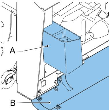
2. Füllen Sie den Flüssigkeitsbehälter **A** bis zum Rand "Max" mit Verschlussflüssigkeit auf.
