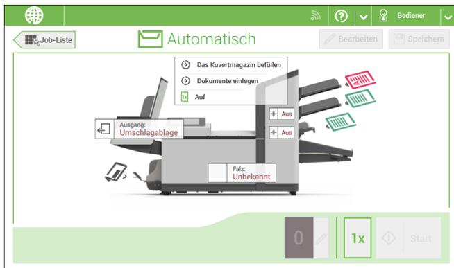
3. Füllen Sie das Kuvertmagazin, legen Sie Ihre Dokumente ein und tippen Sie auf **[1x]**, um eine Testbriefsendung zu erstellen.
