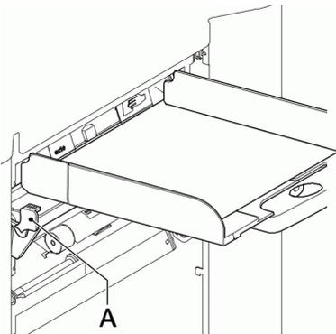
2. Dokumentzufuhrablage zum Entriegeln anheben und anschließend aus der Zuführung ziehen.
