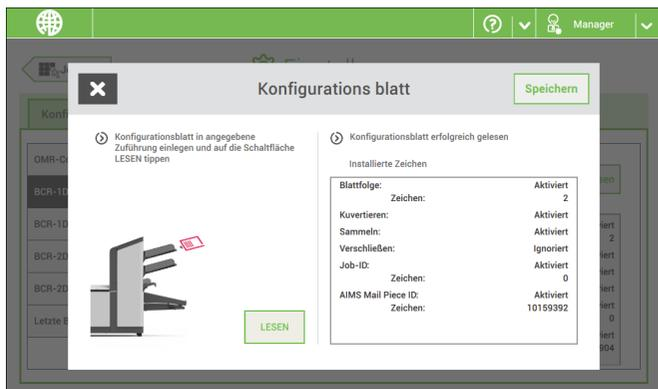
Mithilfe des BCR-1D-Konfigurationsblatts unter "Lesung" können Sie ein Konfigurationsblatt lesen. Das Ergebnis wird auf diesem Bildschirm sowie auf dem Bildschirm "BCR-1D-Codedefinition" dargestellt. Siehe [Lesen eines Konfigurationsblattes](#) auf Seite 94.
