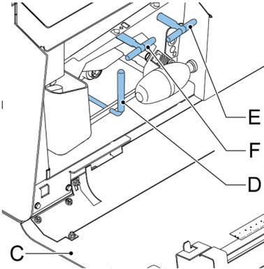
2. Linken Hebel **D** nach unten gedrückt halten und Kuverts aus der unteren Kuvertführung entnehmen
