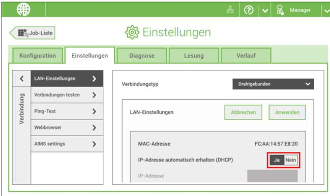
6. Legen Sie für **IP-Adresse automatisch erhalten (DHCP)** entweder **Ja** oder **Nein** fest. Bei "Ja" wird das System automatisch mit dem LAN verbunden. Bei "Nein" muss die Verbindung manuell eingerichtet werden. Geben Sie die erforderlichen Details zur Einrichtung einer manuellen Verbindung ein.
