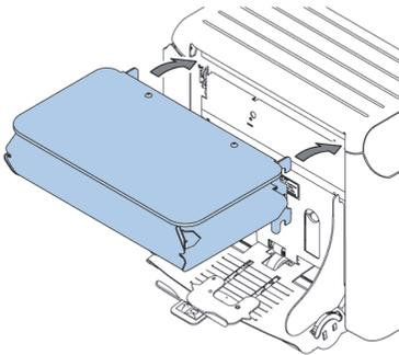
Das System kann mit einem Seitenausgang und einer Ablage ausgestattet werden. Der Seitenausgang kann anstelle der Kuvertablage angebracht werden. Der Seitenausgang ermöglicht das Anbringen eines Transportbands oder eines Frankiersystems am System. Der Seitenausgang kann auch mit einer Ablage verwendet werden, um ein vertikales Stapeln zu ermöglichen. Die Ablage wird zusammen mit dem Seitenausgang geliefert.
