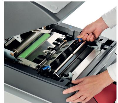
Das Klappschalensystem gestattet eine schnelle Installation des Sets und ermöglicht auch die unkomplizierte Beseitigung eines eventuellen Papierstaus.
